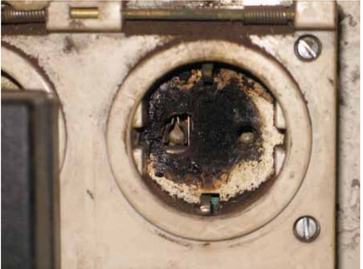
Kuva 13. Hiiltynyt pistorasian pohja.
