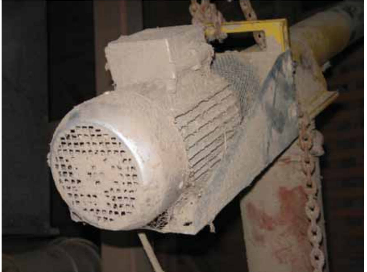
Kuva 5. Pölyn tukkimat moottorin jäähdytysjärjestelmät.
